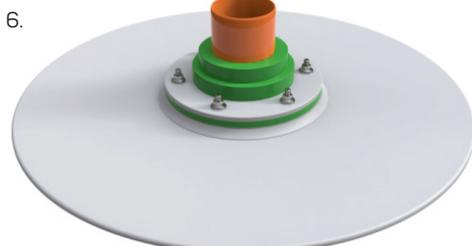
Установите кессон на обсадную трубу. Трубу предварительно очистите и обработайте сантехническим вазелином.
