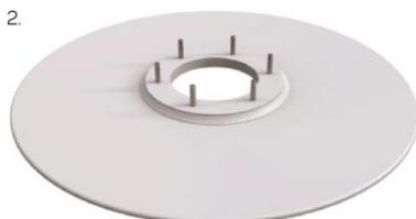
Установите основание муфты с крепежными болтами на дно и приварите с помощью экструдера с внутренней и наружной стороны дна.
