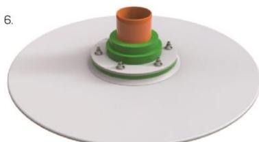
Установите кессон на обсадную трубу. Трубу предварительно очистите и обработайте сантехническим вазелином.
