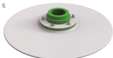
Установите муфту, фланец, наденьте шайбы и не сильно затяните гайки крепления (по диагоналям, с усилием не больше 1.5 Н\*м).
